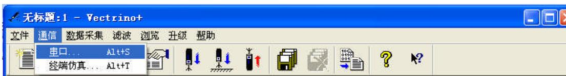
“串口”主要用来设置通信连接，点击“串口”出现如下所示对话框。将仪器连接到计算机的一个端口，从“通信”菜单中指定一个端口号（com1、com2 等），建议你接受默认的波特率（9600 baud），如右下图所示。
